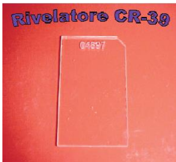
Figura 2 - Rivelatore SSNTD di CR-39
